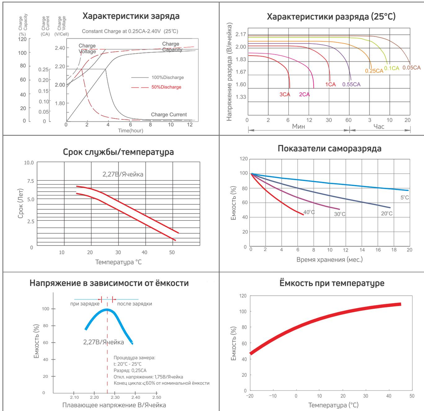
**КОНЕЧНЫЕ ЗНАЧЕНИЯ НАПРЯЖЕНИЯ, РЕКОМЕНДОВАННЫЕ В СООТВЕТСТВИИ С СИЛОЙ ТОКА ПРИ РАЗРЯДЕ**
